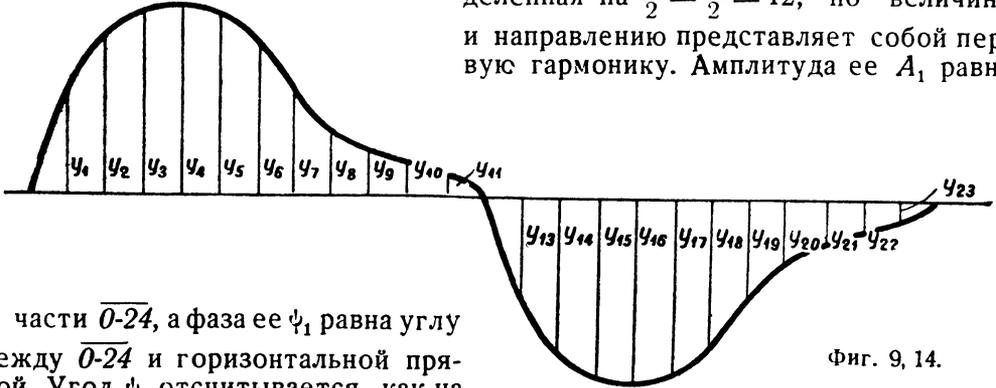
$\frac{1}{12}$  части  $\overline{0-24}$ , а фаза ее  $\psi_1$  равна углу между  $\overline{0-24}$  и горизонтальной прямой. Угол  $\psi_1$  отсчитывается, как на всех векторных диаграммах, против часовой стрелки от горизонтальной линии.
